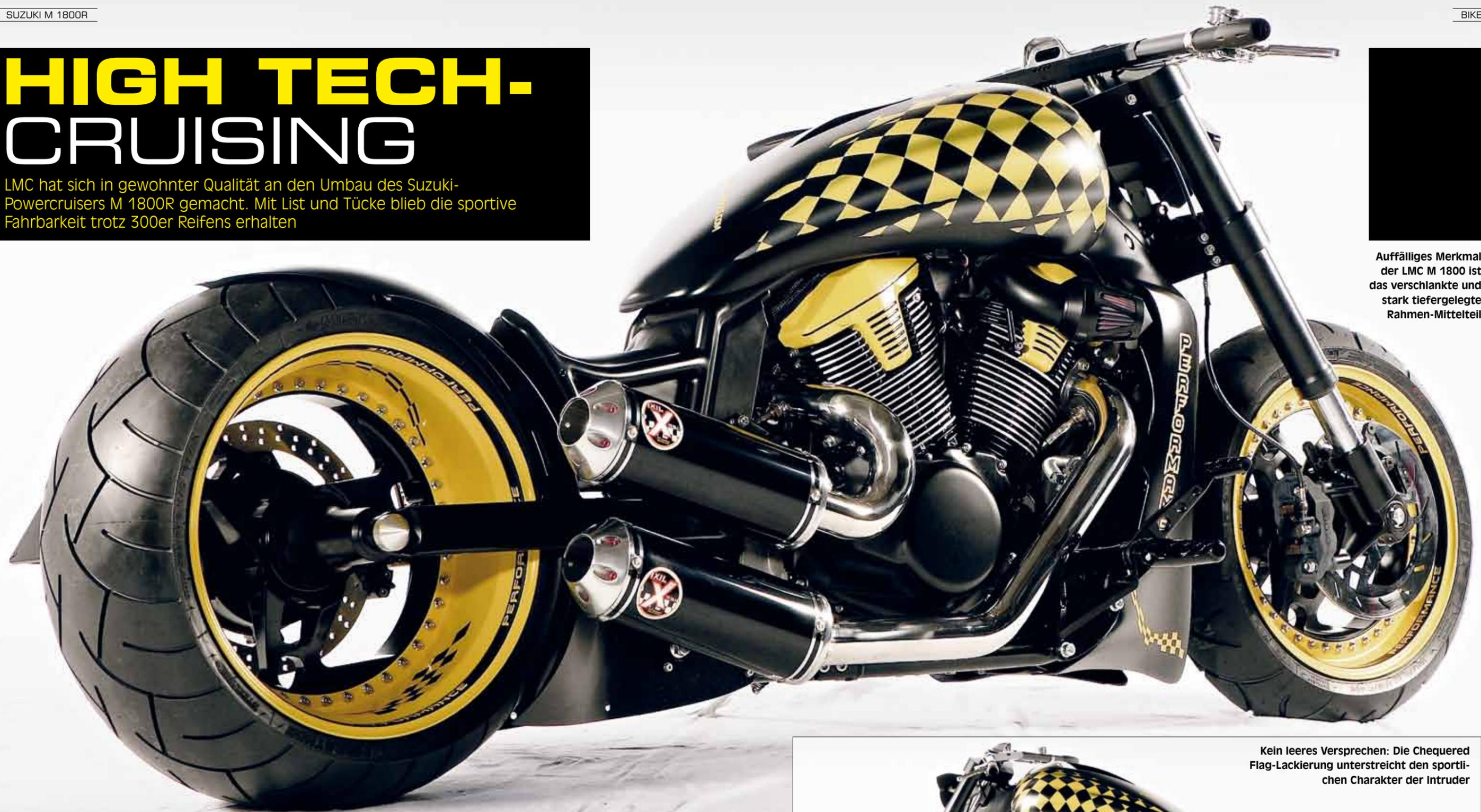
Auffälliges Merkmal der LMC M 1800 ist das verschlankte und stark tiefergelegte Rahmen-Mittelteil
