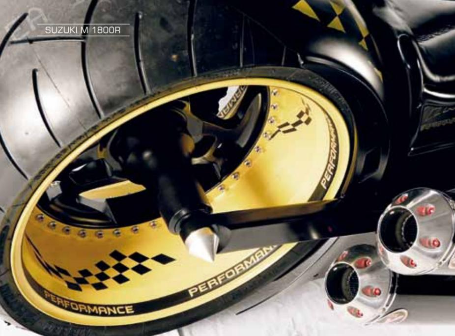
Leicht macht schnell: Felgen mit Karbon-Stern ermöglichen Breitreifen und sparen Gewicht
